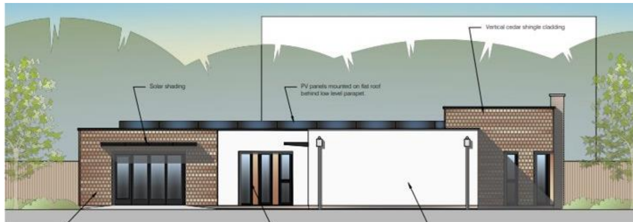
SE Elevation (Side)
